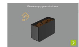
Den Satzbehälter entnehmen, leeren, reinigen und wieder einsetzen. Anschliessend die Pfeiltaste drücken, um zum nächsten Schritt zu gelangen.
