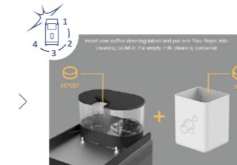
Open de tabletinworp en werp er een koffie-reinigingstablet in. Werp vervolgens een melkreinigingstablet in het lege reinigingsreservoir.
