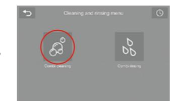
Durch Drücken der KOMBI-REINIGUNGS-Taste wird die Reinigung gestartet.
