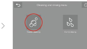
Als er dan op de toets voor COMBI-REINIGING wordt gedrukt, wordt het reinigingsproces gestart.
