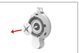
Démonter et nettoyer le mélangeur d'instantané. Voir « Démontage mélangeur d'instantané » ! Veiller à ce que le mélangeur d'instantané soit correctement replacé après nettoyage.
